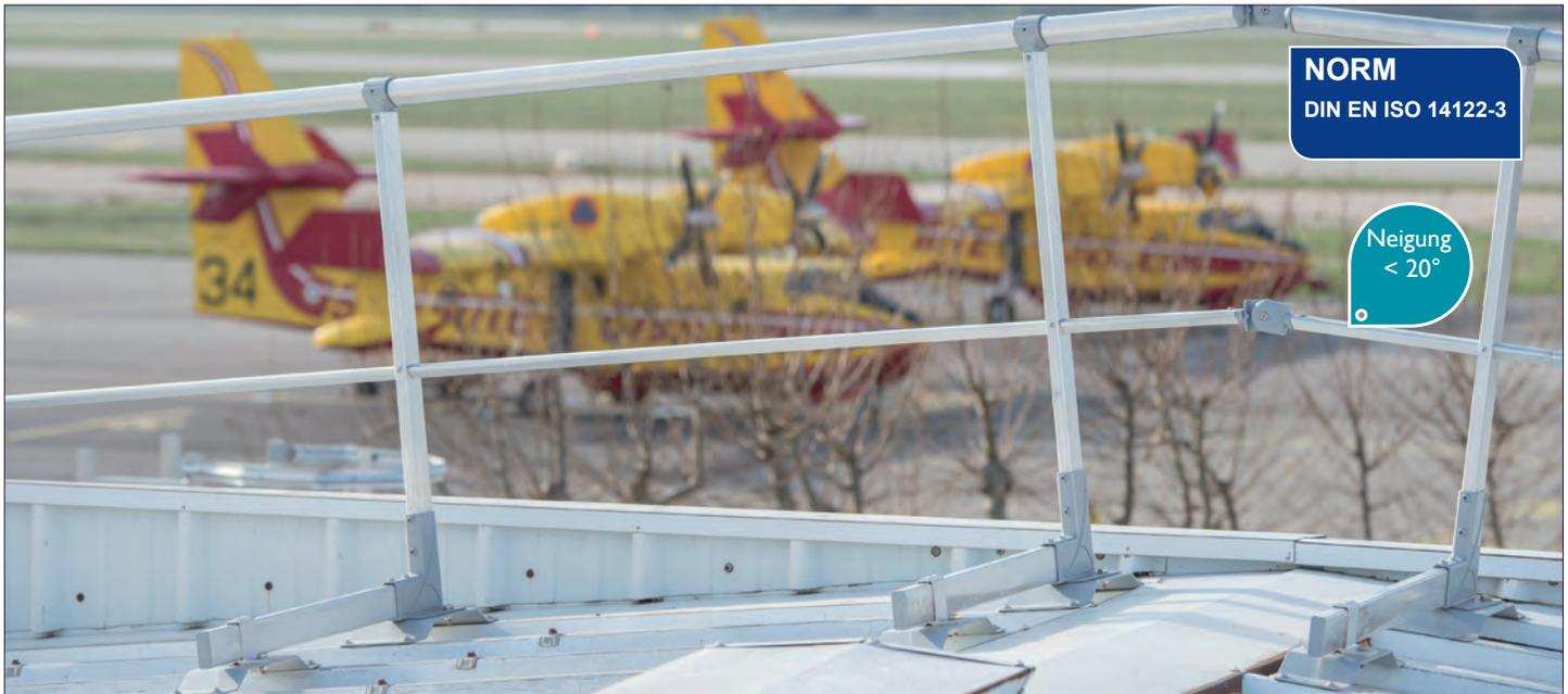
Das Dachgeländer VECTACO® VBA ist eine kollektive Absturzsicherung für Metaldach mit Stahltrapezblech oder Sandwichelement. Das Dachgeländer ist geeignet für die gängigsten Stahltrapezprofile in Europa. Die Standard-Versionen sind für 250 mm und 333 mm Obergurtabstände. Der maximale Abstand zwischen 2 Geländerstützen beträgt 1,50 Meter.
