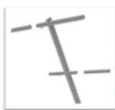
7 - Nach dem Aufstellen des gesamten Geländers die Perfix-Edelstahlschrauben 5,5 x 25 **(6)** durch die Stützen auf Höhe des Handlaufs **(1)** und des Knielaufs **(2)** einschrauben.
