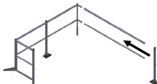
Handlauf ② Ø48mm und Knielauf ③ Ø35mm an die Eckstützen ① montieren. Die Zwischenstützen ④ einfädeln. Die Eckstütze ⑤ montieren. Die beiden Seiten vorbereiten.
