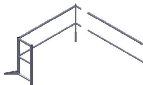
Handlauf ② Ø48mm und Knielauf ③ Ø35mm an die Eckstützen ① und ④ montieren.
