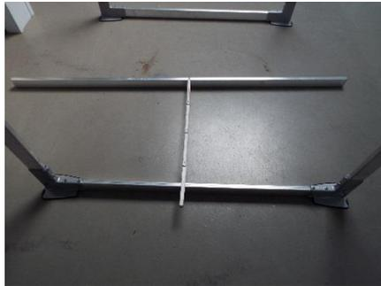
6. montieren der Geländer Rohre VORSICHT: beim reinschieben können Kratzer entstehen
